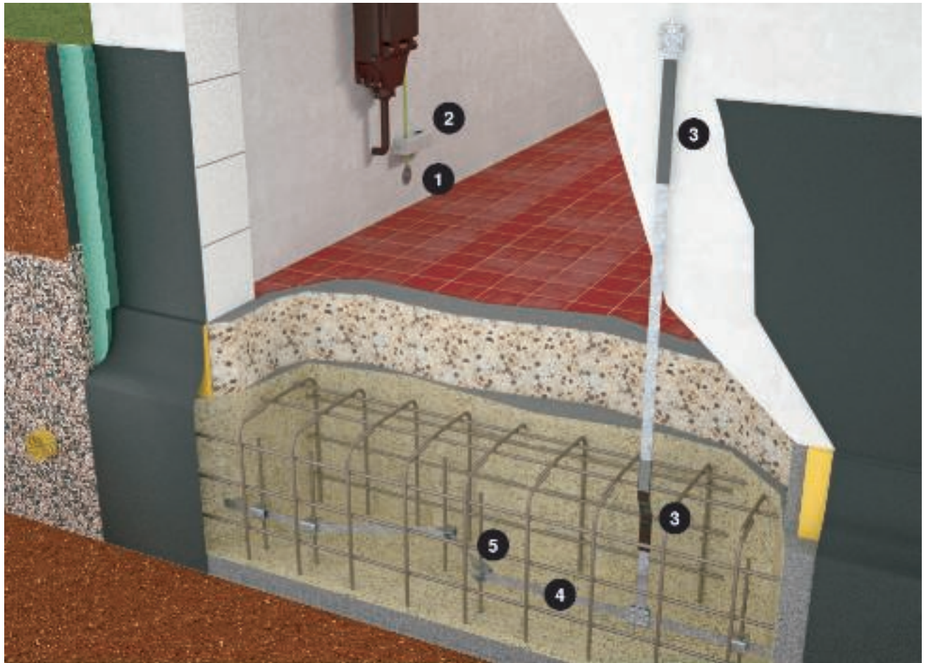
1 = Erdungsfestpunkt, 2 = Potentialausgleichsschiene, 3 = Korrosionsschutzbinden, 4 = Leitungsmaterial, 5 = Anschlussklemmen
