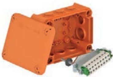
T 100 ED 4-10 D mit 10 Klemmen für Datenkabel mit Aderdurchmesser 0,8 mm Art.-Nr. 7205580
